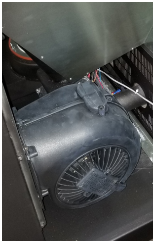
Figure 20 Démontage du ventilateur de convection
