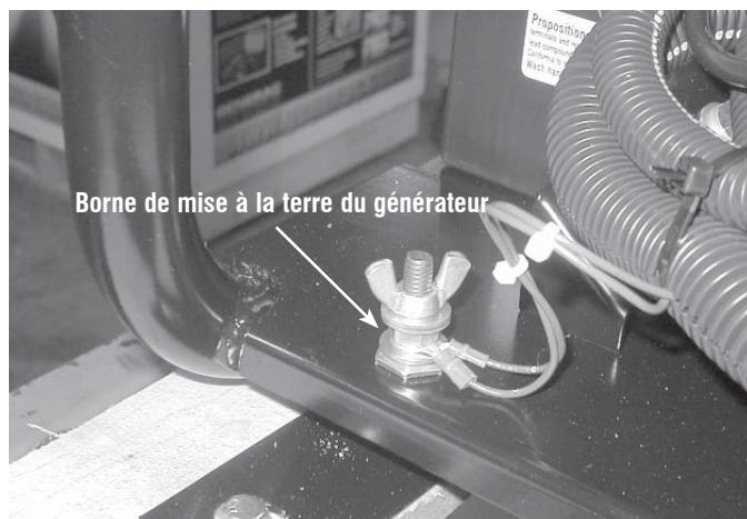
La bonne mise à la terre du générateur aidera à empêcher une électrocution en cas de condition de défaut de mise à la terre dans le générateur ou dans les dispositifs électriques branchés. La bonne mise à la terre aide également à dissiper l'électricité statique, qui s'accumule souvent dans les dispositifs non mis à la terre.
