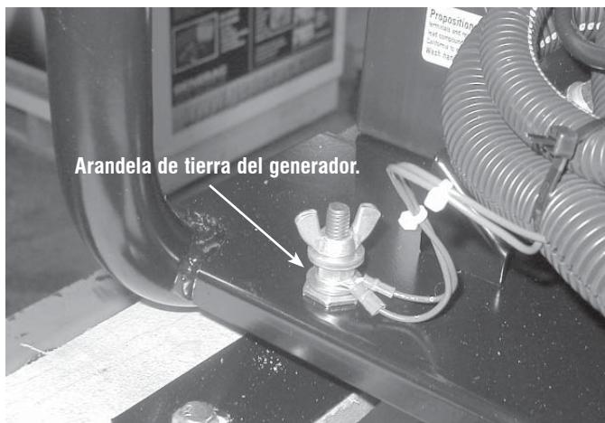
La apropiada conexión a tierra del generador ayudará a evitar una descarga eléctrica en el caso en que se presente una falla de tierra en el generador o en los dispositivos conectados. Una apropiada conexión a tierra también ayuda a disipar la electricidad estática, que generalmente se acumula en dispositivos no enterrados.
