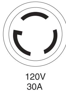
Use este receptáculo para operar cargas monofásicas a 120 voltios AC y 60 Hz que requieran hasta 3600 vatios (3.6 Kw) de potencia a 30 amperios. Esta toma está protegida por un interruptor de circuito de presionar para reiniciar de 30A.
