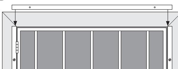
Coloque la jamba de travesaño superior (**C**) a través de la parte superior de las dos jambas de lado. Asegúrate de que hay un mínimo 1/8" espacio entre la jamba y la parte superior del marco de puerta, y la jamba esté nivelada.
