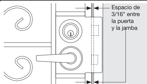
Con los pasadores del cerrojo extendidos, alinear los orificios de cerradura en la jamba del lado de la cerradura (**B**). Deje aproximadamente 3/16" de espacio entre la puerta y la jamba. Asegúrate de que el jamba esté a plomada, y la parte superior es el nivel de la parte superior de la jamba del lado de la bisagra.
