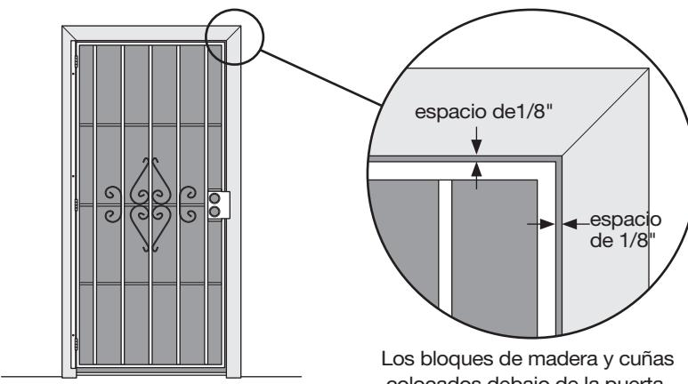
Coloque el ensamblado de la jamba de la puerta/lado de la bisagra (**A**) frente a la abertura. Dejar un espacio de 1/8" entre el borde de la puerta, del lado de la cerradura, y el borde interior de tu superficie de montaje; además, debes dejar un espacio de 1/8" entre el borde superior de la puerta (no la mosca delgada correa soldada en el borde del marco de la puerta en determinados modelos) y el borde inferior de tu superficie de montaje. Asegúrate de que el ensamblado esté a plomada.
