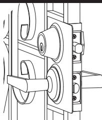
Adjunte su elección de cerraduras con el respaldo de 2-3 / 8 ". Extienda completamente los pernos de bloqueo en la posición "bloqueada".
