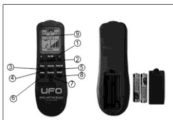
1. Marche / Arrêt : permet d'allumer l'appareil lorsqu'il est en veille ou de l'éteindre lorsqu'il est en marche.
