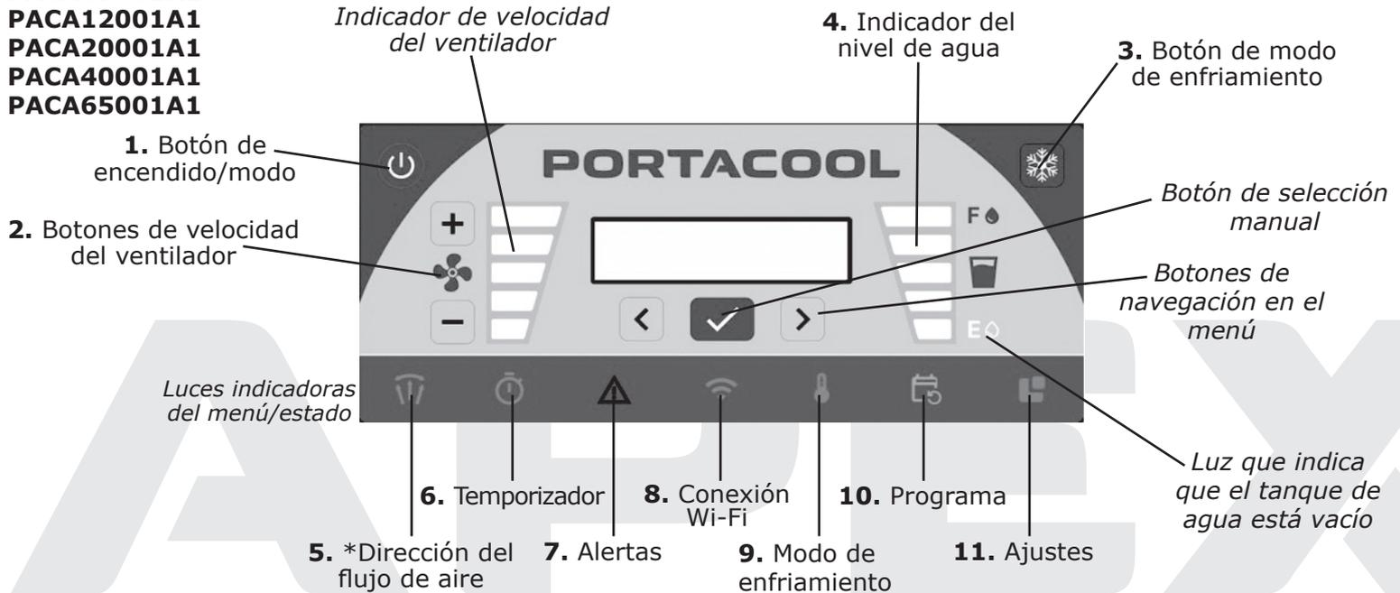
\*Función únicamente habilitada en modelos con rejillas de aire: **PACA05001A1**, **PACA07001A1**.
