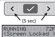
Pour verrouiller l'écran, appuyer simultanément sur les deux boutons fléchés du menu pendant 5 secondes. Pour le déverrouiller, appuyer à nouveau sur les boutons pendant 5 secondes.
