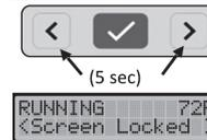
Para bloquear la pantalla, presione simultáneamente ambos botones de flecha en el menú por 5 segundos. Para desbloquearla, vuelva a presionar y sostener los botones por 5 segundos.
