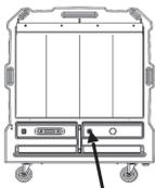
Remplir le réservoir ou fixer le tuyau d'eau. Nous recommandons d'utiliser le raccord pour tuyau avec une vanne d'arrêt automatique.
