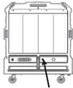
Llene el tanque o conecte una manguera de agua. Recomendamos utilizar la conexión de manguera con una válvula de cierre automático.
