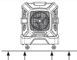
Installer le refroidisseur sur une surface plane quand il est utilisé. Verrouiller les roulettes.
