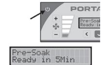
Presionar el botón de encendido en el enfriador comenzará una función de remojo previo para el medio. Durante este remojo previo, el ventilador funcionará a baja velocidad (la pantalla LCD mostrará un temporizador en cuenta regresiva).
