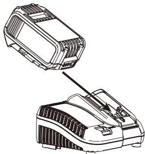
2. Insérer le bloc-piles dans le chargeur, en vous assurant qu'il y est correctement calé. Le voyant rouge (charge) clignotera de façon continue indiquant que le cycle de chargement a commencé.
