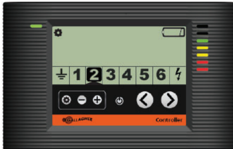
Kontroll visar zon 2 med en låg batterinivå
