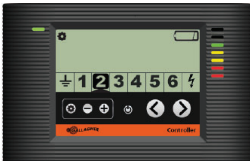
Controlador mostrando la zona 2 con batería baja
