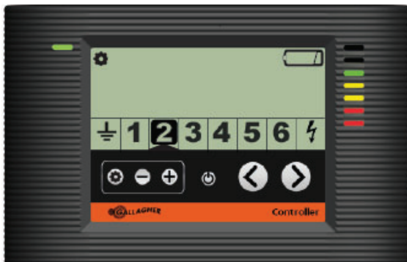
Styreenheden viser zone 2 med et lavt batteri
