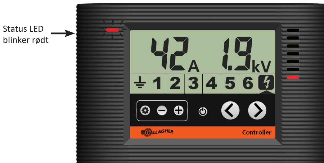
Kontrolleren viser, at spændingsgiveren har udløst en udgangsalarm
