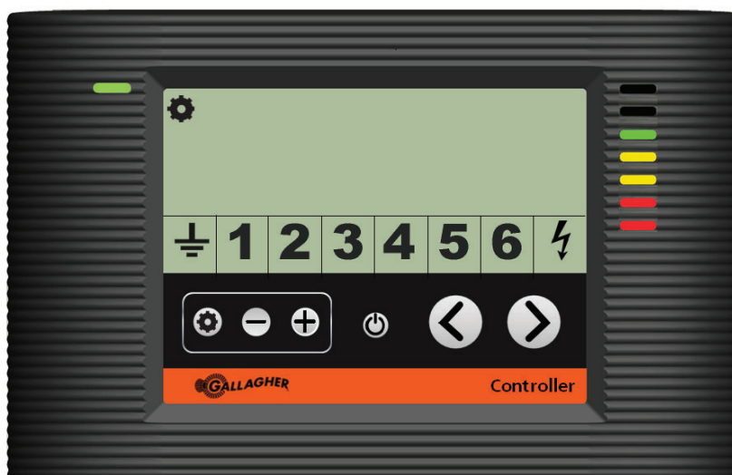
Kontrolleren viser udgangsspænding, der bliver justeret.
