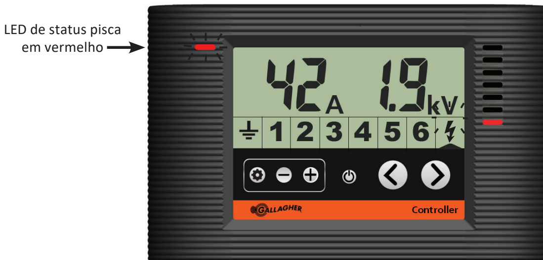
Controlador mostrando o energizador em alarme de corrente
