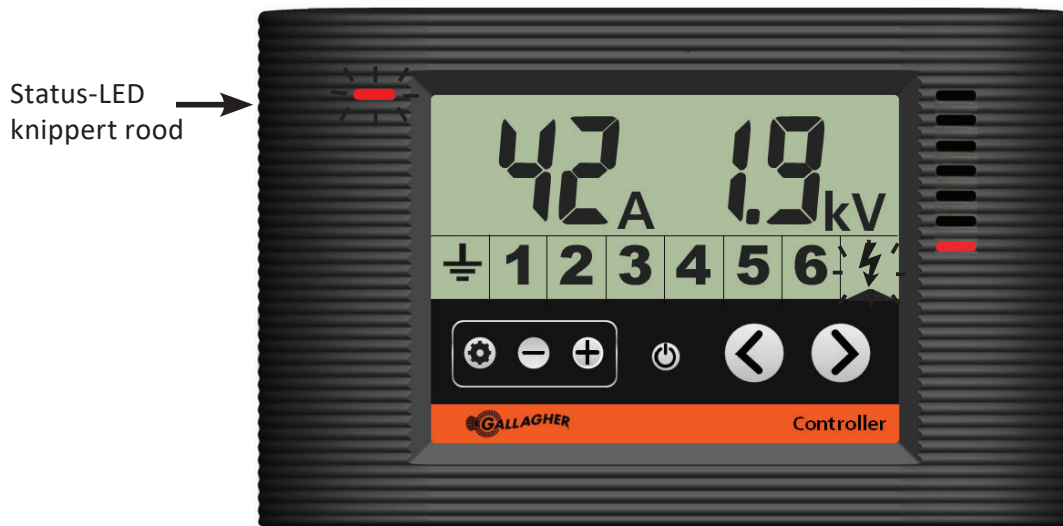
Bedieningspaneel toont het schrikdraadapparaat in stroomsterktealarm
