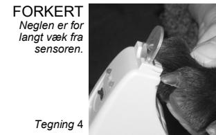
Klipperen og sensoren er designede til at fungere korrekt når skærebladene er ved den rigtige vinkel til neglen. Hold neglen ved den rigtige vinkel til klipperbladene igennem processen. Sensoren registrerer blodet i nerven, men vil også registrere blodet i dit kæledyrs pote eller i din egen finger. Det er vigtigt at det kun er nerven i dit kæledyrs negl der bliver påvist og ikke blodet fra din hånd eller dit kæledyrs pote. Sørg for at holde poten og din hånd og fingre væk fra sensoren.
