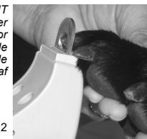
Steek, met de sensor klaar om het vlees te lezen, de nagelpunt in het knipgat. Zorg ervoor dat u de nagel richting de sensor houdt (zie afbeelding 3) en niet naar buiten houdt richting het insteekgat te ver weg van de sensor (Zie afbeelding 4).
