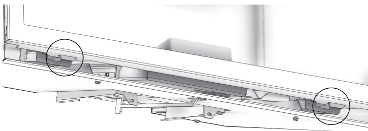
2. Tirez les loquets à ressorts vers l'extérieur et vers le haut pour libérer le bas du foyer.
