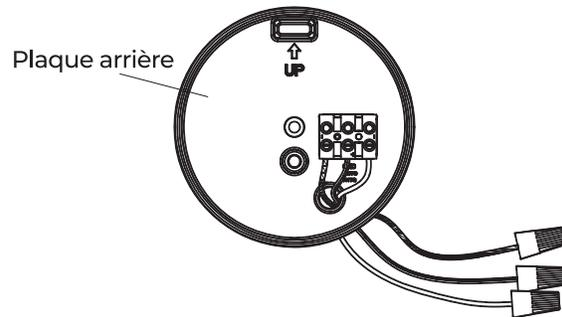
4. Placez la plaque arrière contre la boîte de sortie, insérez la vis du support de montage dans le trou de la plaque arrière, vissez la vis du support de montage dans le trou central de la barre de montage. Serrez fermement la vis du support de montage.
