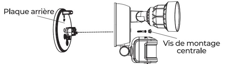
3. Connectez les fils de la source de la boîte de sortie avec les fils de la plaque arrière à l'aide de serre-fils comme suit :
