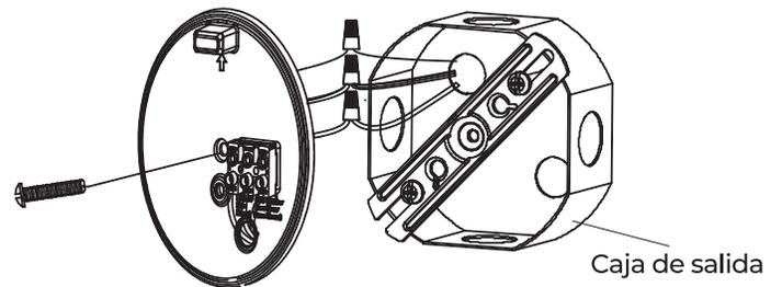
5. Fije la lámpara a la placa trasera con el tornillo de montaje central:
