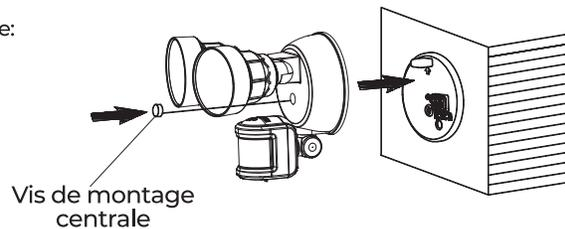
6. À l'aide d'un composé de calfeutrage à base de silicone, calfeutrez complètement autour de l'endroit où le luminaire rencontre la surface du mur pour empêcher l'eau de s'infiltrer dans la boîte de sortie.
