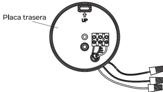
4. Coloque la placa posterior contra la caja eléctrica, inserte el tornillo del soporte de montaje a través del orificio de la placa posterior, enrosque el tornillo del soporte de montaje en el orificio central de la barra de montaje. Apriete firmemente el tornillo del soporte de montaje.
