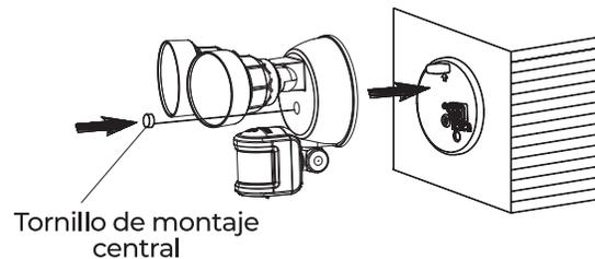
6. Usando un compuesto de calafateo de silicona, calafatee completamente alrededor de donde la lámpara se encuentra con la superficie de la pared para evitar que el agua se filtre en la caja de salida.
