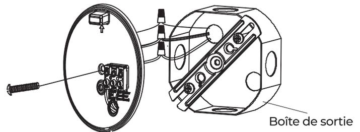
5. Fixez le luminaire à la plaque arrière à l'aide de la vis de montage centrale:
