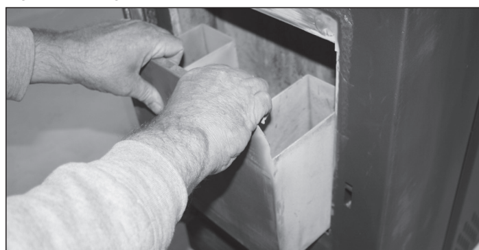
Figure 34 : Vider le cendrier.
