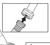
CONNECT THE HOSE TO SPRINKLER END FITTING
