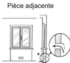
Exemples des trous de ventilation pour l'air comburant.
