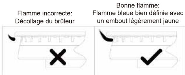
Fig.23 (Modèles de bonne et de mauvaise flammes)
