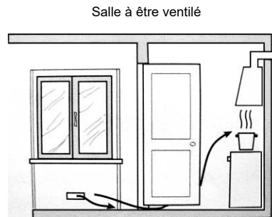
Agrandissement de la fente de ventilation entre la fenêtre et le plancher
