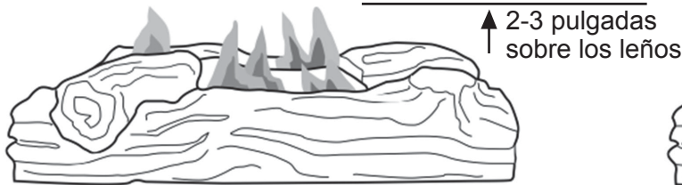
Fig. 22 - Patrón correcto de la llama del quemador
