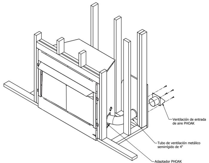
Figura 14: instalación sencilla del kit de ventilación exterior
