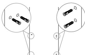
Para superficies de montantes de pared, taladre un orificio de 3 mm (1/8") en las marcas guía. Para superficies de muro en seco, perfore un orificio de 6 mm (1/4") a través de las marcas guía e inserte anjados de plástico para pared.
