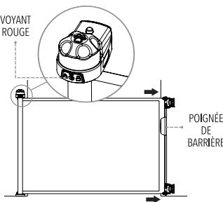
Étendez la barrière en tirant sur la poignée de la barrière vers les supports de poignées et en les accrochant sur les supports de poignée supérieurs et inférieurs. Assurez-vous que la barrière est en position déverrouillée en vérifiant que le voyant est rouge. Cela permettra à la barrière de s'ouvrir librement.
