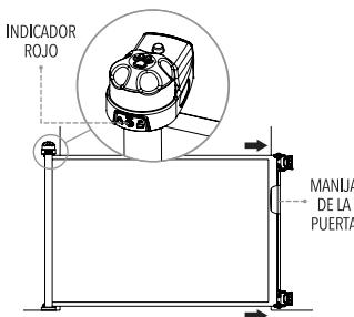
Extienda la puerta tirando de la manija de la puerta hacia los montajes de la manija y engáncelas en los montajes de manija superiores e inferiores. Asegúrese de que la puerta esté en posición desbloqueada verificando la ventana del indicador rojo. Esto permitirá que la puerta se abra libremente.
