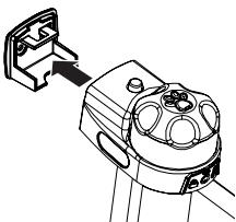
Con la parte inferior de la puerta conectada al montaje inferior, empuje la parte superior de la puerta hacia el montaje superior para asegurarla en su lugar.
