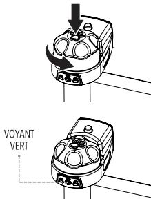
Pour verrouiller la barrière en place, poussez sur le capuchon supérieur et tournez dans le sens contraire des aiguilles d'une montre jusqu'à ce que la barrière se ferme. Assurez-vous que la barrière est verrouillée en vérifiant que le voyant est vert. Pour déverrouiller, tournez le capuchon supérieur dans le sens des aiguilles d'une montre jusqu'à ce que la barrière s'ouvre.
