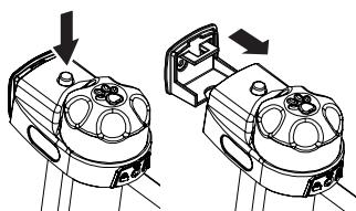
Retire la puerta presionando y sosteniendo el botón de liberación de bloqueo circular mientras desliza la puerta hacia afuera del montaje superior y hacia arriba del montaje inferior.
