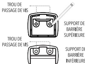
Utilisez le modèle de montage mural en papier A (H) pour vous aider à marquer les emplacements exacts où fixer les pièces de montage de la barrière. Pour utiliser le modèle de montage mural en papier, placez-le contre le mur avec le bord inférieur du modèle en contact avec le sol. Vous pouvez choisir d'utiliser un appareil de mesure ou un niveau pour assurer un positionnement exact. Marquez l'emplacement des trous de vis des pièces de montage de la barrière à travers le gabarit et sur le mur.
