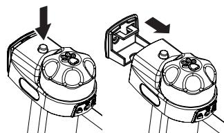
Retirez la barrière en appuyant sur le bouton de déverrouillage circulaire du loquet et en le maintenant enfoncé tout en faisant glisser la barrière vers l'extérieur à partir du support supérieur et vers le haut à partir du support inférieur.
