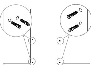
Pour les surfaces de poteaux muraux, percez un trou de 3 mm (1/8") à travers les marques de guidage. Pour les surfaces de cloison sèche, percez un trou de 6 mm (1/4") à travers les marques-guides et insérez les ancrages muraux en plastique.
