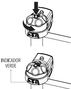
Para bloquear la puerta en su lugar, empuje hacia abajo la tapa superior y gírela en sentido contrario a las agujas del reloj hasta que se detenga. Asegúrese de que la puerta esté bloqueada revisando la ventana del indicador verde. Para desbloquear, gire la tapa superior en el sentido de las agujas del reloj hasta que salga.
