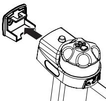
Avec le bas de la barrière connectée au support de barrière inférieure, poussez le haut du portail vers le support de barrière supérieur pour la fixer en place.
