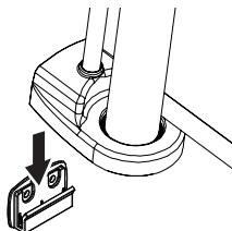
Para fijar la puerta retráctil (A), alinee la parte inferior de la puerta por encima del montaje inferior de la puerta mientras la desliza hacia abajo.
