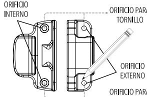
Repita el paso 1 en el lado opuesto de la pared usando la **plantilla de montaje en pared** de papel B (I) para ayudar a marcar las ubicaciones exactas para fijar los montajes de la manija.
