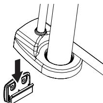
Pour fixer la barrière rétractable (A), alignez le bas de la barrière au-dessus du support de barrière inférieure tout en la faisant glisser vers le bas.
