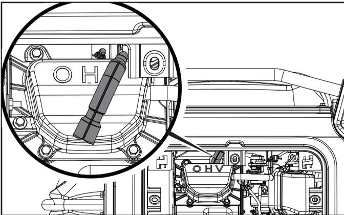
3. Use una herramienta para bujías (no incluido), o un dado de 13/16 in. (21 mm) (no incluido) para remover la bujía.
