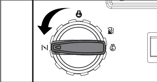
3. Retire la cubierta de mantenimiento del lado de drenaje de aceite empujando y girando los dos sujetadores en sentido contrario a las agujas del reloj hasta la posición horizontal desbloqueada.
