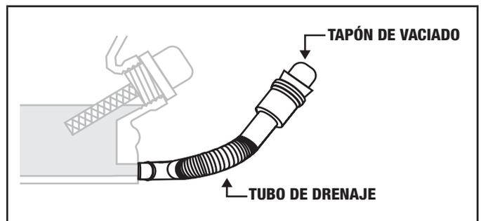
5. Utilice alicates para deslizar la abrazadera del muelle hacia abajo de la manguera de drenaje de aceite y tire de la manguera del soporte del enchufe.
