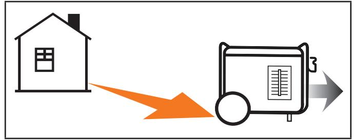
Si es mal usado y operado en una locación que resulta en la acumulación de CO adentro de un espacio cerrado o parcialmente cerrado, por ejemplo una casa, garaje o garaje con la puerta parcialmente abierta, el CO Shield® automáticamente apagará el motor y después iluminará una luz LED roja. Lea la etiqueta de acción para los pasos que debe tomar. **El CO Shield® no es un sustituto para una alarma de detección de monóxido de carbono para el interior.**
