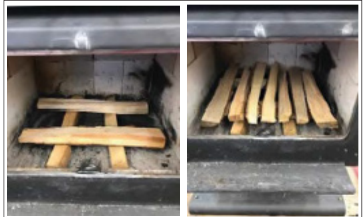
Figura 18 Combustible de encendido
