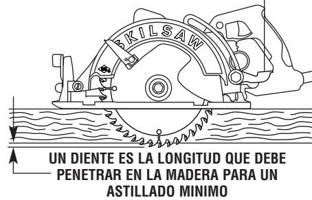
PALANCA DE AJUSTE DE PROFUNDIDAD FIG. 3
