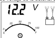
La pantalla digital muestra la tensión de la batería conectada durante 10 segundos. El medidor sin el puntero se iluminará sólido. Durante este periodo, pulsar el botón de verificación de voltaje de batería devolverá la unidad al modo espera. La unidad volverá al modo espera automáticamente después de 10 segundos.
