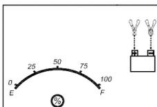
Si las abrazaderas están conectadas INCORRECTAMENTE con respecto a polaridad, la pantalla del LCD demostrará lo siguiente (el signo "+" y el signo "-" dentro del icono de la batería y el icono de fallo destellará y los iconos de la pinza, la icono de la batería y el medidor sin el puntero se iluminan) y una advertencia sonará hasta que las pinzas sean separado:
