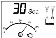
La pantalla digital muestra la cuenta regresiva.\* El indicador de carga de la batería indicará el estado de carga actual de la batería. El icono de arranque del motor parpadea. Los iconos de abrazadera y el icono de la batería se iluminan de manera continua, y las barras en el icono de la batería cambiarán de vacías a sólidas (de abajo hacia arriba) repetidamente y los iconos de flecha se moverán gradual y repetidamente hacia abajo hasta el icono de la batería.
