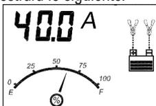
El indicador digital demuestra la corriente a la que se está cargando la batería. El medidor indica el estado de carga de la batería. Los iconos de las pinzas y el icono de batería sólido iluminar; y las barras en el icono de la batería cambian de vacío a sólida (abajo a arriba) repetidamente y los iconos de flecha gradualmente y repetidamente mover abajo hacia en el icono de la batería.
