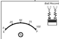
Los iconos de reacondicionamiento de la batería, el icono de las pinzas, el icono de batería se iluminarán sólido y el medidor sin el puntero se iluminará sólido; y las barras en el icono de la batería cambian de sólida a vacío (arriba a abajo) repetidamente y los iconos de reacondicionamiento de la batería parpadearán.
