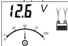
La pantalla digital muestra la tensión de la batería conectada durante 10 segundos. Durante este periodo, pulsar el botón de verificación de voltaje de batería devolverá la unidad al modo de carga. La unidad volverá al modo carga automáticamente después de 10 segundos.
