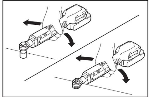
**AVISO:** Una torsión de apriete excesiva puede dañar el perno/tuerca, el dado o la herramienta.
