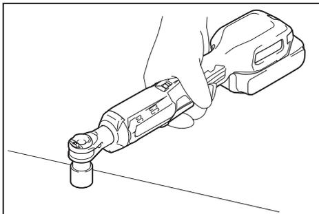
La herramienta también funciona sin dado. El orificio del adaptador puede apretar un perno/tuerca tipo 8 mm (5/16"). (funciona como un dado de 13 mm)
