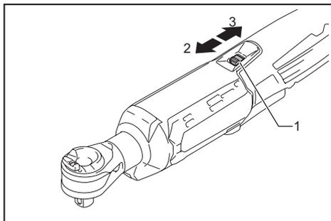
► 1. Palanca de bloqueo 2. Bloqueo 3. Desbloqueo
