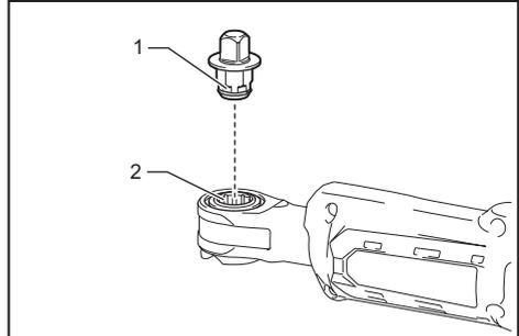
► 1. Adaptador del dado 2. Orificio del adaptador
