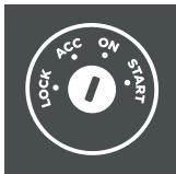
POSICIONES DE IGNICIÓN DE TOYOTA
