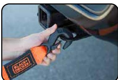
1. Conecte la cuerda a la máquina / vehículo que está desactivado. Asegúrese de asegurarla en el gancho de remolque de un vehículo o en una parte del marco para que no dañe el vehículo.
