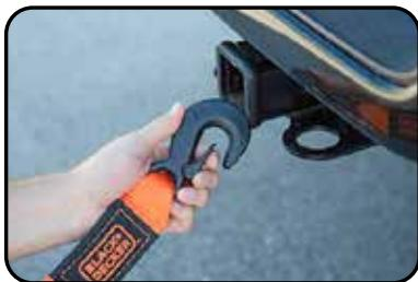
2. Attachez l'autre extrémité de la corde au véhicule que vous utilisez pour le remorquage. De nombreux véhicules ont des crochets ou des boucles que vous pouvez utiliser, mais si vous n'en avez pas, trouvez une partie du châssis du véhicule. La traverse sous le moteur peut être le meilleur endroit pour attacher un câble de remorquage.
