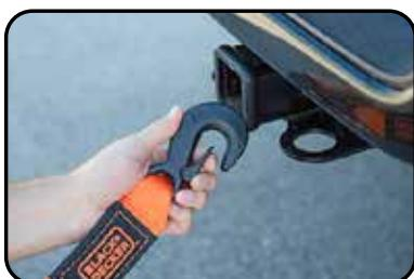
2. Conecte el otro extremo de la cuerda al vehículo con el que va a remolcar. Muchos vehículos tienen ganchos o bucles que puede usar, pero si no tiene uno, busque una parte del marco del vehículo. El travesaño debajo del motor puede ser la mejor zona para sujetar un cable de remolque.
