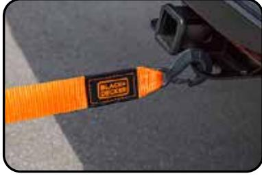
3. Una vez que la correa esté sujetada a ambos vehículos, tire lentamente del vehículo remolcador para eliminar la holgura adicional de la correa. Una vez que se aprende la correa, acelere lentamente a muy baja velocidad hasta que el vehículo averiado comience a moverse.
