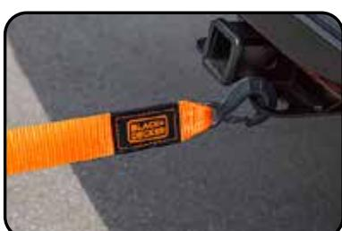
3. Une fois la corde attachée aux deux véhicules, tirez lentement sur le véhicule tracteur pour retirer le mou supplémentaire de la corde. Une fois la corde informée, accélérez lentement à très basse vitesse jusqu'à ce que le véhicule en panne soit libre.
