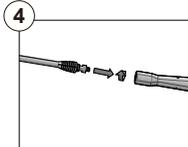
Una la pistola de la hidrolavadora a presión a la lanza de pulverización.
