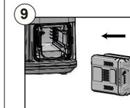
Instalación de la batería.
