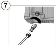
Enrosque la válvula de cebado en la salida del limpiador a presión y gire en sentido horario hasta que quede apretada. Una vez instalada, tome el extremo de la manguera de alta presión incluida y apriete en la válvula.
