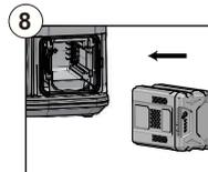
Instalación de la batería.
