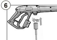
Introduzca un extremo de la manguera de alta presión en el acoplamiento de entrada y gire en sentido horario.
