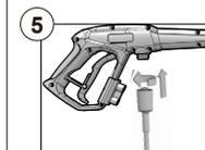
Introduzca un extremo de la manguera de alta presión en el acoplamiento de entrada y gire en sentido horario.
