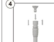
Coloque la punta para presión deseada.
