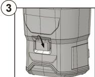
Levante y empuje hacia abajo la hebilla del cubo para fijar el cubo.
