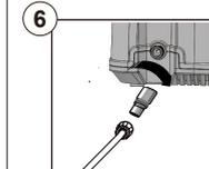
Coloque la válvula en el limpiador de alta presión y apriétela girándola en sentido horario. Una vez instalada, coja el extremo de la manguera de alta presión suministrada y acóplela a la válvula.
