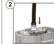
Tire hacia atrás del collar del adaptador y acople el conector macho a la máquina.
