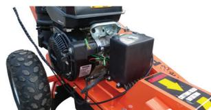
DUAL DIRECT V-BELT 3600 RPM DRIVE
