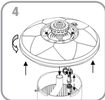
**Étape 6.** Pour nettoyer la pompe, retirez le couvercle de la roue pour exposer l'ensemble de la turbine. Retirez l'ensemble de la turbine en tirant doucement sur les pales de la turbine. La roue est maintenue en place par un aimant. Utilisez un chiffon doux ou une brosse et une eau chaude pour nettoyer la roue et l'intérieur du carter de la turbine.
