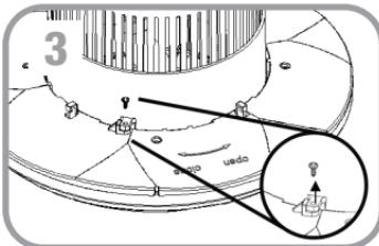
**Paso 4.** Gire la sección superior a la izquierda. Luego, tire de la sección superior de la parte inferior retirando el tubo de la sección superior. Deberá desatornillar el conector de alambre en el interior del fuente para quitar completamente la parte superior del fuente de la parte inferior.
