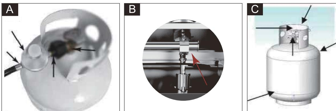
5. Tournez lentement le robinet de la bouteille de GPL dans le sens inverse des aiguilles d'une montre jusqu'à la position ouverte.
