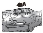
1. Pulse el interruptor de encendido/apagado para encender.
