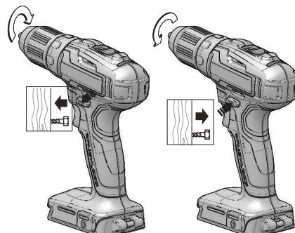
1. Lorsque l'interrupteur marche arrière se trouve à gauche du bouton marche/arrêt, la direction de la mèche est vers l'avant (serrage).
