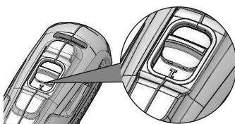
La máquina tiene un interruptor de dos velocidades diseñado para perforar o atornillar a velocidades LO (1) o HI (2). En la parte superior de la máquina hay un interruptor deslizante.
