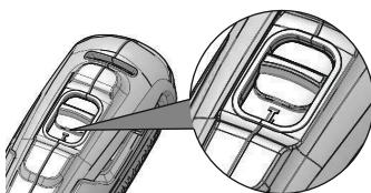
La machine est munie d'un interrupteur à deux vitesses conçu pour percer ou visser à basse (LO) vitesse (1) ou haute (HI) (2). Un interrupteur coulissant se trouve sur le dessus de l'appareil.
