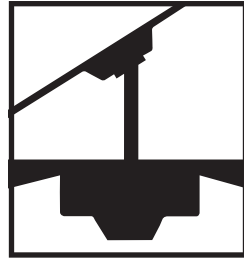
Instalación en techo abovedado
