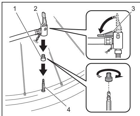
4. Pliegue firmemente la pinza del mandril neumático.
