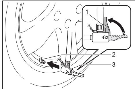
► 1. Air chuck clamp 2. Valve stem 3. Air chuck
