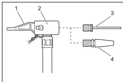
► 1. Dispositif de serrage du mandrin pneumatique
