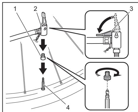
► 1. Adaptateur de valve Presta 2. Mandrin pneumatique 3. Dispositif de serrage du mandrin pneumatique 4. Corps de valve
