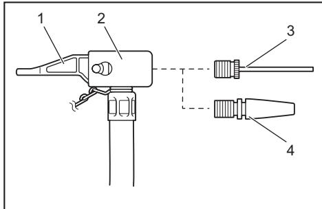
3. Pliegue firmemente la pinza del mandril neumático.
