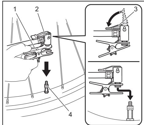
► 1. Adaptateur de valve Dunlop 2. Mandrin pneumatique 3. Dispositif de serrage du mandrin pneumatique 4. Corps de valve
