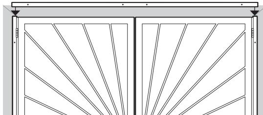
Coloque la jamba de travesaño superior (**C**) a través de la parte superior de las dos jambas de lado. Asegúrate de que hay un mínimo 1/8" espacio entre la jamba y la parte superior del marco de puerta, y la jamba esté nivelada.
