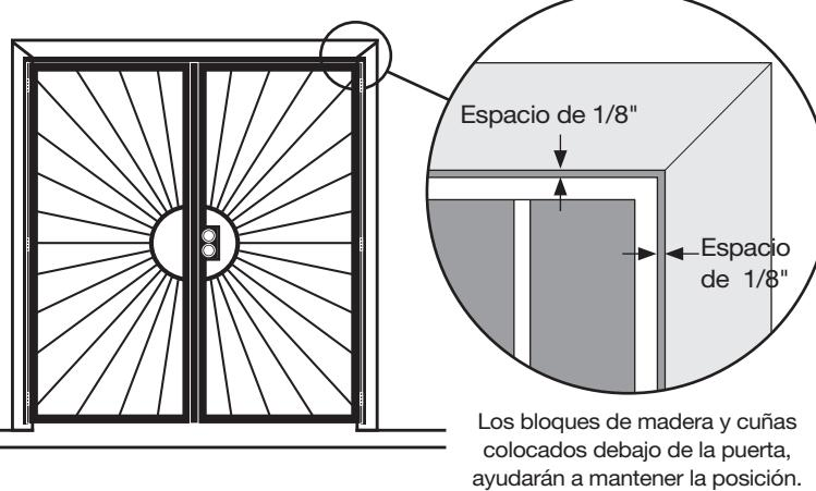
Position el secundario de la puerta de bisagra y asamblea de jambas laterales (**A**) en la parte delantera del ado correcto de la apertura. Dejar un espacio de 1/8" entre el borde de la puerta, del lado de la cerradura, y el borde interior de tu superficie de montaje; además, debes dejar un espacio de 1/8" entre el borde superior de la puerta y el borde inferior de tu superficie de montaje. Asegúrate de que el ensamblado esté a plomada.
