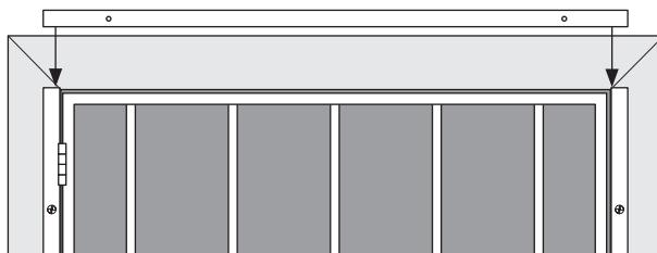
Coloque la jamba de travesaño superior (**C**) a través de la parte superior de las dos jambas de lado. Asegúrarse de que hay un mínimo 1/8" espacio entre la jamba y la parte superior del marco de puerta, y la jamba esté nivelada.
