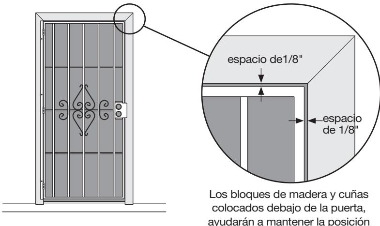
Coloque el ensamblado de la jamba de la puerta/lado de la bisagra (**A**) frente a la abertura. Dejar un espacio de 1/8" entre el borde de la puerta, del lado de la cerradura, y el borde interior de tu superficie de montaje; además, debes dejar un espacio de 1/8" entre el borde superior de la puerta (no la mosca delgada correá soldada en el borde del marco de la puerta en determinados modelos) y el borde inferior de tu superficie de montaje. Asegúrate de que el ensamblado esté a plomada.
