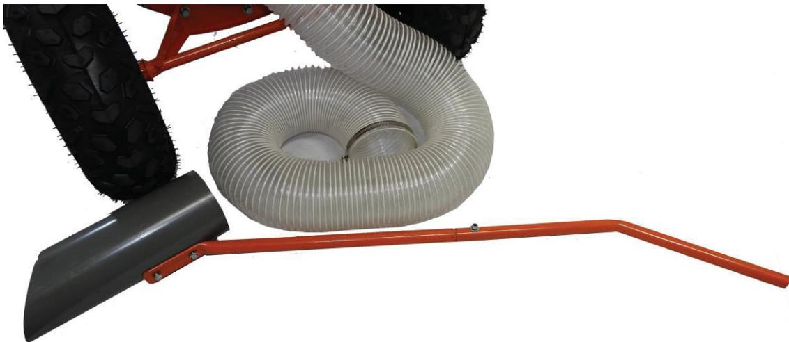
2. Fixez la buse au tuyau avec le collier de serrage.
