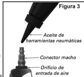
**Extremo del accionamiento:** Para mantener el máximo rendimiento de la herramienta neumática, debe lubricarla en cada utilización. La horquilla y la caja del trinquete pueden calentarse, si esta área de la herramienta neumática no está lubricada durante la utilización de la herramienta neumática. Puede lubricar manualmente la herramienta entre la horquilla y la caja del trinquete, como se muestra (vea Figura 4).
