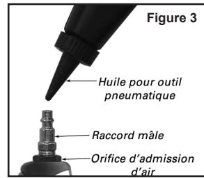
**Extrémité d'entraînement :** Pour maintenir la performance maximale de l'outil pneumatique, il doit être lubrifié à chaque utilisation. La bride et le boîtier du cliquet peuvent devenir très chauds, si cette zone de l'outil pneumatique n'est pas lubrifiée pendant l'utilisation de l'outil pneumatique. L'outil peut être lubrifié manuellement entre la bride et le boîtier du cliquet, tel qu'ilustré (voir figure 4).
