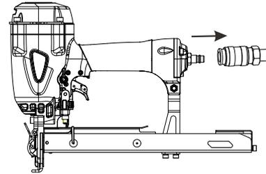
2. Gire la herramienta de forma tal que la entrada de aire dé hacia arriba. Coloque 2 a 3 gotas de aceite neumático de la herramienta de la cerradura en la entrada de aire. No utilices aceite detergente ni aditivos puesto que estos lubricantes causarían el desgaste acelerado de los sellos y amortiguadores de la herramienta, lo que resultará en el mal funcionamiento de la misma y elevará la frecuencia del mantenimiento.
