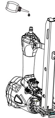
3. Después de agregar el aceite, haga funcionar la herramienta por un breve periodo. Limpie el exceso de aceite de la salida de la cubierta.
