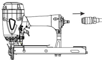
2. Tournez l'outil de façon à ce que l'entrée d'air soit orientée vers le haut. Appliquez 2 ou 3 gouttes d'huile pour outil de fixation pneumatique dans l'entrée d'air. N'utilisez pas d'huile détergente, d'additif pour essence ou d'huile à outil pneumatique. N'ajoutez pas d'huile détergente ni d'autres additifs : ces lubrifiants accéléreraient l'usure des joints et des butoirs de l'outil, ce qui nuirait à son rendement et augmenterait la fréquence des entretiens.
