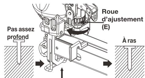
Tournez le bouton de réglage de la ajustement dans le sens des aiguilles d'une montre.
