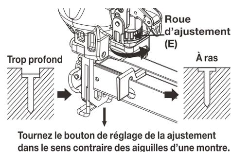
Tournez le bouton de réglage de la ajustement dans le sens contraire des aiguilles d'une montre.
