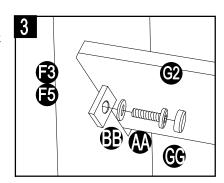
4. Raccordez le tube décoratif inférieur (G2) au poteau (F4) à l'aide de boulons (AA) et de rondelles plates (BB), et couvrez-les avec les capuchons en plastique (GG). Serrez le tout à l'aide de la clé hexagonale (Z1).
