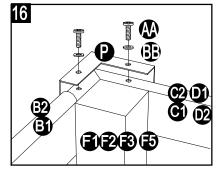
17. Raccordez les traverses courtes (A1 et A2) au raccord de traverse (A3) à l'aide de boulons (AA) et de rondelles plates (BB). Serrez le tout à l'aide de la clé hexagonale (Z1).
