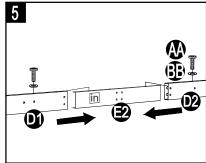
6. Fixez les traverses arrière assemblées (D1 et D2) aux poteaux (F3 et F5) à l'aide de boulons (AA), de rondelles plates (BB) et de rondelles à ressort (CC). Assemblez-les de l'intérieur. Ensuite, couvrez-les avec les capuchons en plastique (GG). Serrez le tout à l'aide de la clé hexagonale (Z1).
