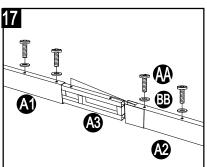
18. Fixez les traverses courtes assemblées (A1 et A2) à la traverse arrière gauche (D1), à la traverse arrière droite (D2), à la traverse avant courte (C1) et à la traverse avant longue (C2) à l'aide de boulons (AA) et de rondelles plates (BB). Ensuite, couvrez-les avec les capuchons en plastique (GG). Serrez le tout à l'aide de la clé hexagonale (Z1).
