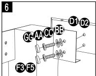
7. Raccordez les traverses arrière assemblées (D1 et D2) aux poteaux (F3 et F5) à l'aide de boulons (DD) et de rondelles (II), assemblez-les de l'extérieur. Serrez le tout à l'aide de la clé hexagonale (Z1).
