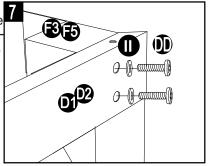
8. Raccordez les traverses arrière assemblées (D1 et D2) aux poteaux (F4) à l'aide de boulons (DD) et de rondelles (II). Serrez le tout à l'aide de la clé hexagonale (Z1).
