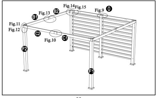
Fixez le couvercle de traverse (O) aux traverses arrière assemblées (D1 et D2) à l'aide de boulons (AA) et de rondelles plates (BB). Serrez le tout à l'aide de la clé hexagonale (Z1).
