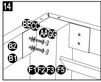
15. Raccordez les traverses (B1 et B2) aux poteaux (F1, F2, F3 et F5) à l'aide de boulons (DD) et de rondelles (II).
