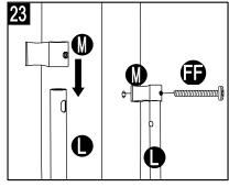
24. Fixez le raccord de tube pour la toile (M) au tube pour la toile (L) à partir du bas à l'aide de boulons (FF). Serrez le tout à l'aide de la clé hexagonale (Z1).
