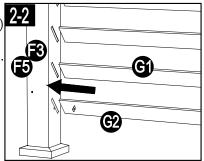
Raccordez le tube décoratif inférieur (G2) aux poteaux (F3 et F5) à l'aide de boulons (AA) et de rondelles plates (BB). Ensuite, couvrez-les avec les capuchons en plastique (GG). Serrez le tout à l'aide de la clé hexagonale (Z1).
