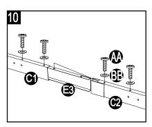
11. Fixez les traverses avant assemblées (C1 et C2) aux poteaux (F1 et F2) à l'aide de boulons (AA), de rondelles plates (BB) et de rondelles à ressort (CC). Assemblez-les de l'intérieur. Ensuite, couvrez-les avec les capuchons en plastique (GG). Serrez le tout à l'aide de la clé hexagonale (Z1).
