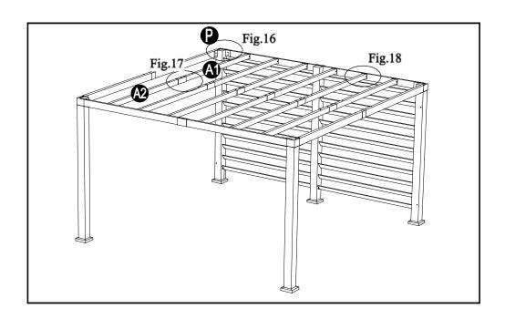
16. Fixez le couvercle de coin (P) à la traverse courte du côté court (B1) et à la traverse longue du côté court (B2) à l'aide de boulons (AA) et de rondelles plates (BB). Serrez le tout à l'aide de la clé hexagonale (71).
