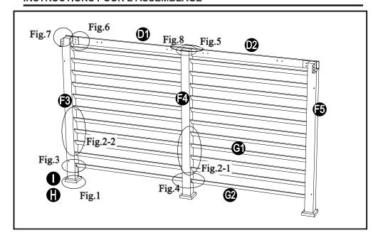
1. Fixez le capuchon de base (I) aux poteaux (F1, F2, F3, F4 et F5). Ensuite, fixez la base (H) aux poteaux à l'aide de boulons (AA) et de rondelles plates (BB). Serrez le tout à l'aide de la clé hexagonale (Z1).
