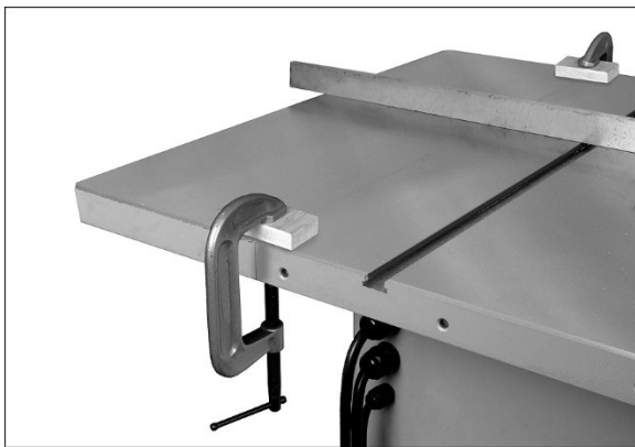
Figura 6-5: nivelación de las alas de extensión, método 2
