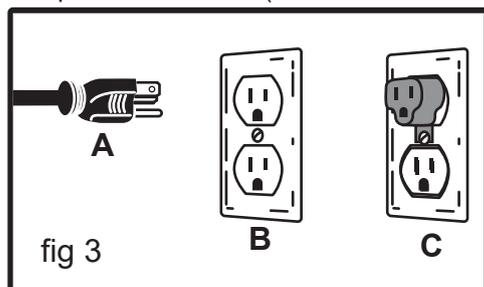
terre) pour la faire entrer dans une prise murale ou une rallonge de 2 trous. Si une prise d'adaptateur est utilisée (C, fig. 3), elle doit être fixée à la vis métallique du réceptacle.
