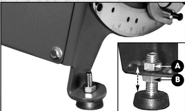
Installez les pieds de nivellement tel qu'illustré ci-dessus. Au besoin, ajustez la hauteur des pieds de nivellement en desserrant les écrous supérieurs **A** et inférieurs **B**.
