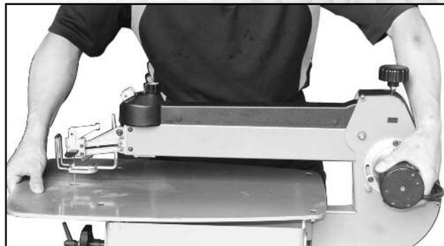
Soulevez plutôt la scie en tenant l'avant de la table d'une main et le moteur (à l'arrière de la scie) de l'autre main.
