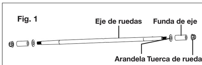
2. Inserte el eje de ruedas en las dos patas de soporte, y re-ensamble las arandelas y la funda del eje (Fig. 2).
