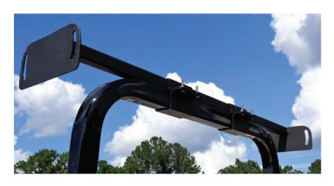
SLOTTED UNIVERSAL CROSSBAR ALLOWS CANOPY TO BE ADJUSTED TO LEVEL
