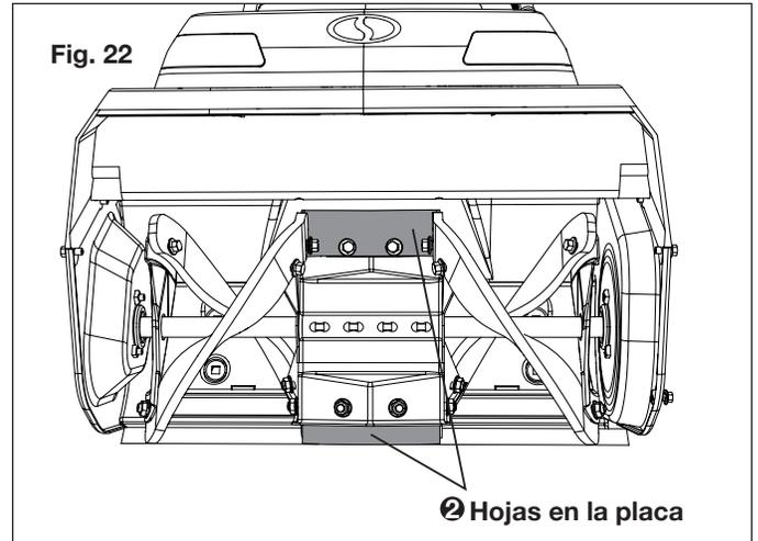
1. Para retirar la primera hoja del lado, use una llave de 10 mm para sujetar fijamente el perno, y use una llave de 13 mm para aflojar y retirar la tuerca. Repita la operación para retirar los tres juegos de perno y tuerca, y delicadamente retire la hoja de la barrena (Fig. 23).
