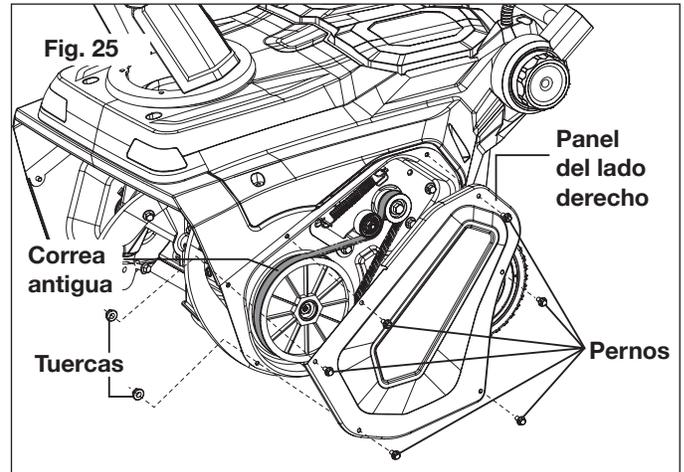
**NOTA:** los dos pernos ubicados a la izquierda tienen dos tuercas en la parte trasera, mientras que los otros cuatro no. Primero use una llave de 10 mm para sujetar los dos pernos de la izquierda, y con la otra llave de 10 mm retire las tuercas. Finalmente, retire todos los pernos.
