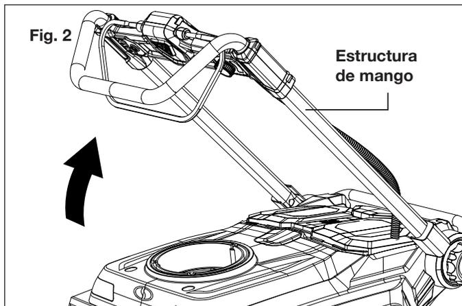
3. Trabe la estructura de mango girando en sentido antihorario las trabas de estructura de mango en ambos lados (Fig. 3).
