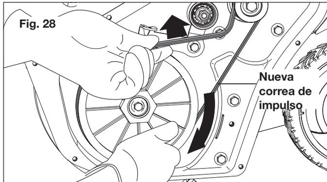
**NOTA:** rote la nueva correa de impulso primero alrededor de la polea del motor, luego alrededor de la polea intermedia, y finalmente alrededor de la polea de barrena. Gire lentamente la polea de barrena en sentido horario para meter la correa hacia dentro (Fig. 29).
