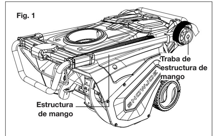
2. Rote la estructura de mango hacia arriba, a una posición de operación cómoda (Fig. 2).
