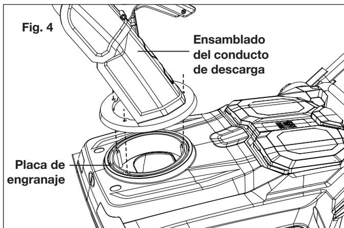
2. Use los tres tornillos de conducto de descarga para asegurar el ensamblado de conducto de descarga a la placa de engranaje, tal como se muestra. Apriete con la llave hexagonal suministrada (Fig. 5).
