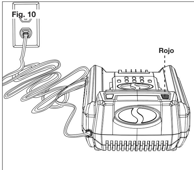
**⚠ ¡PRECAUCIÓN!** El cargador iON100V-RCH está clasificado solo para un voltaje entre 100 V y 120 V CA. NO ENCHUFE el cargador en ningún tomacorriente que tenga un voltaje mayor. El cargado de batería con sobretensión dañará tanto a la batería como al cargador, y puede hacer que el cargador se queme.
