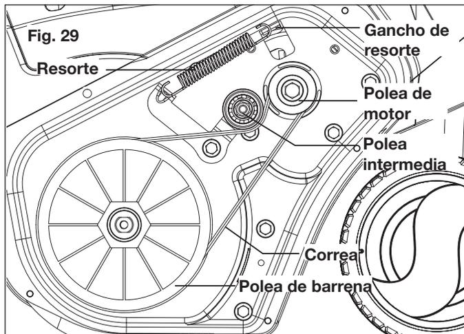
6. Use el alicate de punta fina para reinstalar el resorte en el gancho para tensionar la correa. Vuelva a colocar el panel lateral en la unidad, y asegúrelo con el hardware original. El quitanieve está listo para usarse.
