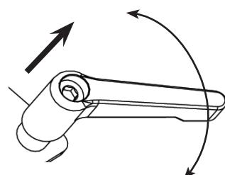
Votre semoir vient avec 2 poignées ajustables pour des réglages rapides et faciles de la lame du marqueur de rangée et de la charrue
