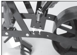
Alignez la plaque de base du marqueur de rangée à l'aide des 4 orifices correspondants sur l'assemblage de la trémie/roue, comme il est indiqué.
