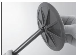
Desserrez l'écrou de la lame et glissez-la sur la tige du marqueur de rangée.
