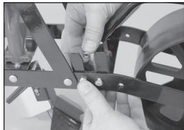
Une fois les trous alignés, insérez 4 boulons et fixez les 4 écrous.
