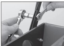
Utilice una llave de 10 mm para sujetar la tuerca y otra llave de 10 mm para asegurar el perno. Ajuste los 4 pernos para asegurar la manija al ensamblado de la argolla/rueda.
