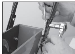
Avec les 4 écrous et les 4 boulons, fixez la barre de la poignée à l'assemblage de la trémie/roue, comme il est montré
