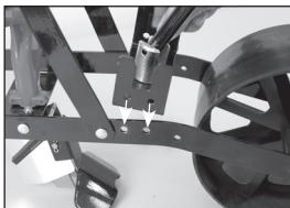
Alíneel la placa base del marcador de surcos con los 4 hoyos correspondientes en el ensamblaje de la argolla/rueda, como se indica.
