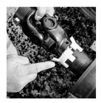
20. Remove the PTO shear bolt.
