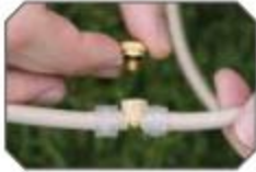
Install nozzles Instale las boquillas
