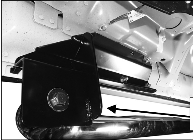
(Fig. 5) Installation du support avant côté passager
