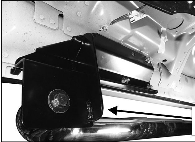
(Figura 5) Instalación del soporte delantero del lado del pasajero
