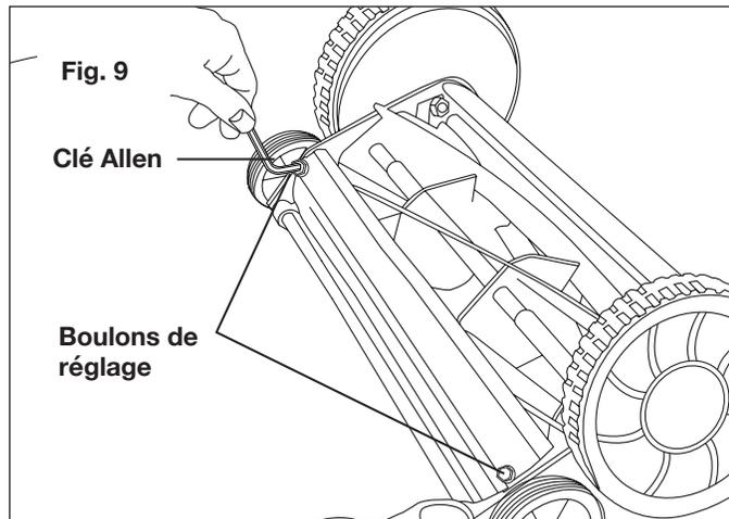
**⚠ AVERTISSEMENT!** Ne pas trop serrer les vis de réglage, car cela pourrait endommager le guide de coupe. Les deux vis doivent être serrées lors du réglage final.
