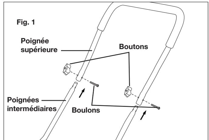
2. Attachez l'ensemble poignée supérieure et intermédiaire à la poignée inférieure en utilisant les boutons et boulons. Serrez les boutons de chaque côté pour bien attacher les poignées (Fig. 2).
