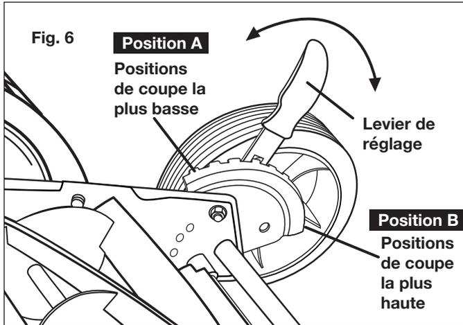
4. Le réglage sur les autres positions de coupe s'effectue en déplaçant les leviers de réglage entre la position la plus haute et la position la plus basse.
