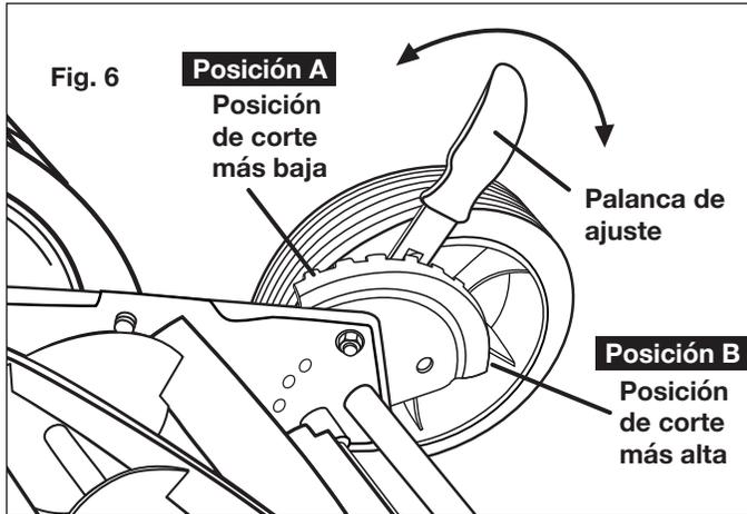
4. Se pueden obtener otras alturas de corte moviendo las palancas de ajuste a las posiciones entre la más alta y más baja.
