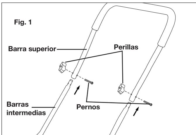
2. Conecte el ensamblado de barras superior e intermedias a la barra inferior usando las perillas y pernos restantes suministrados. Ajuste las perillas en cada lado para garantizar un ajuste seguro (Fig. 2).
