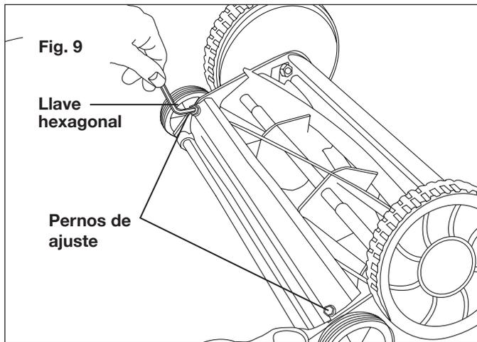
**⚠ ¡ADVERTENCIA!** No apriete demasiado los tornillos de ajuste ya que esto puede dañar la barra de corte. Ambos tornillos deberán estar apretados para el ajuste final.
