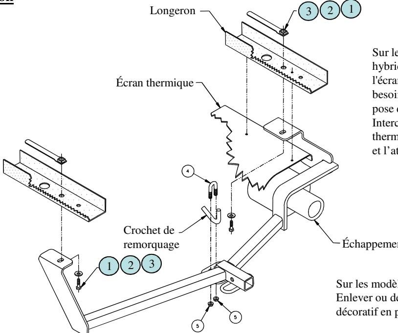
Sur les modèles hybrides : Découper l'écran thermique au besoin pour permettre la pose de l'écrou à levier. Intercaler l'écran thermique entre le cadre et l'attelage.
